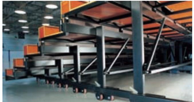
La structure portante de l'élément mobile (gradin) de la tribune télescopique est composée de deux glissières et du châssis du plancher. Chaque glissière est constituée d'un montant en profil fermé et d'une traverse inférieure en « C », qui contient les roues de coulissement.
