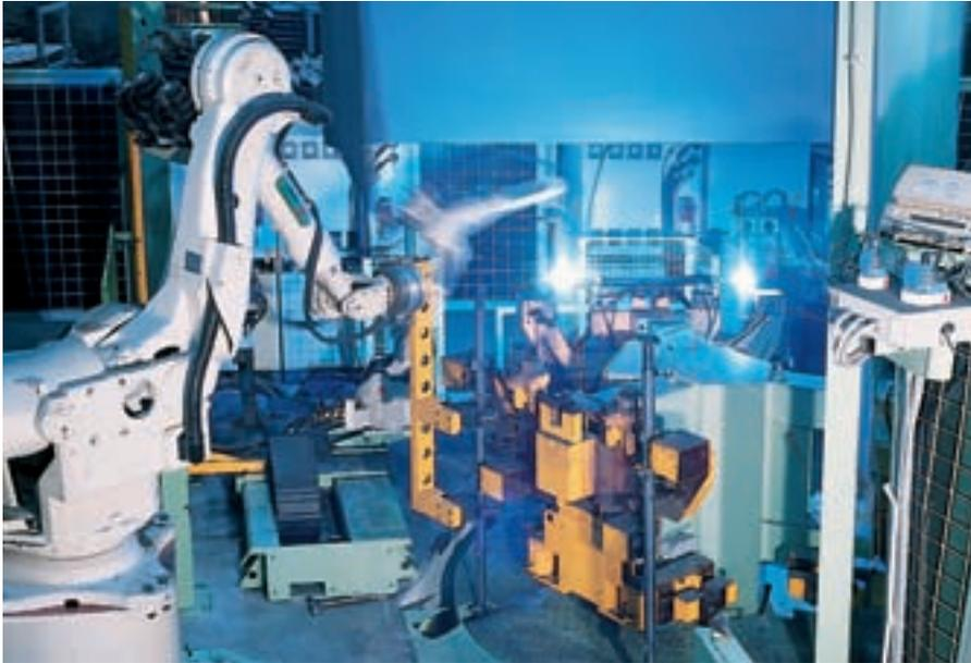
Zone robotisée pour le soudage des châssis.
