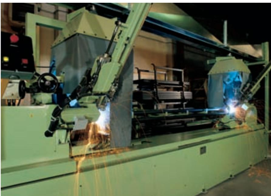
Machine automatique pour le soudage des solives Multiceta®.
