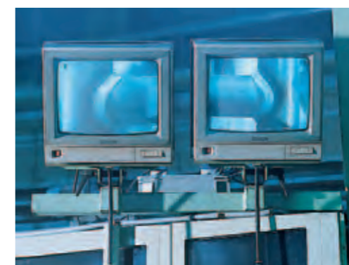
A sinistra: spessimetro elettronico per la verifica di zinco e vernici di protezione.
