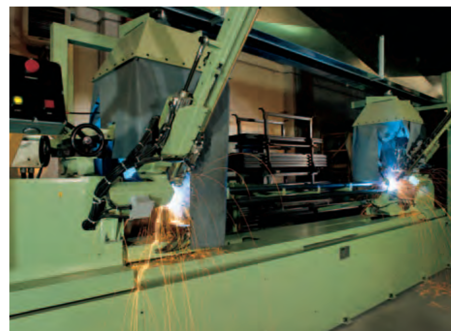
Macchina automatica per la saldatura dei correnti Multiceta.
