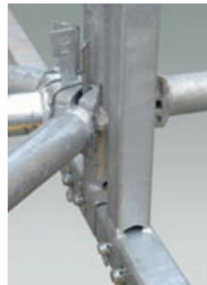
Chaque poutre est connectée à une autre avec les normales moises et diagonales du système **MULTICETA®**, ou dans certains cas particuliers avec le système tube et collier (voir la photo : détail de la jonction entre les poutres avec goujon, pivot, goupille et nœud **MULTICETA®**).
