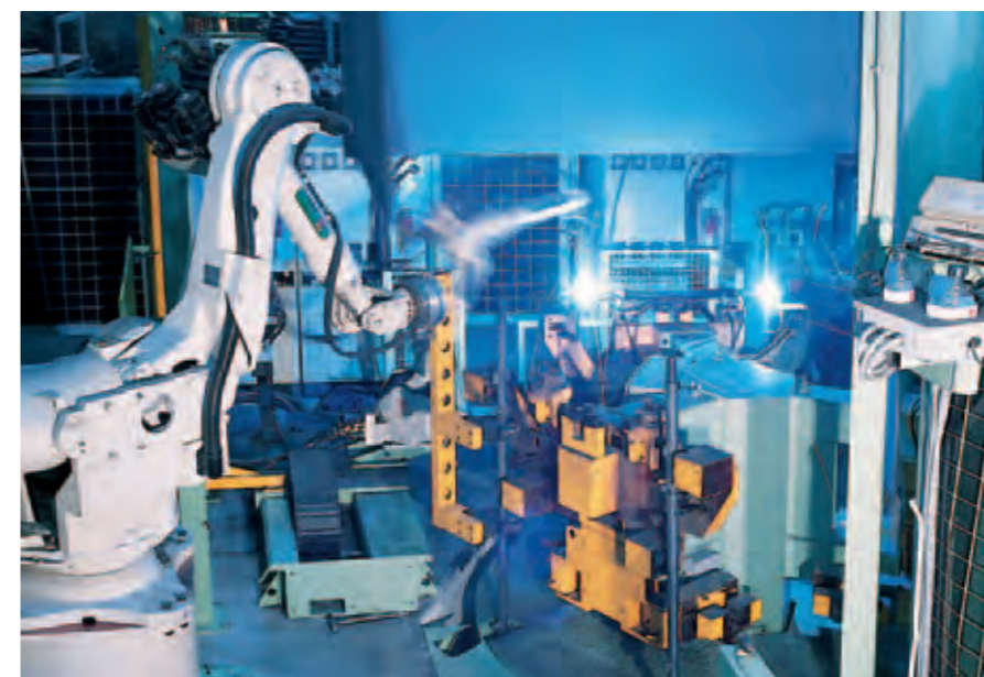
Isola robotizzata per la saldatura dei telai.
