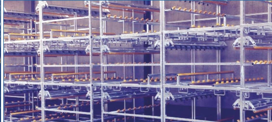
Il catalogo CETA comprende anche **contenitori** speciali per la movimentazione di parti di automobili di lusso. Ciascun pezzo, così come gli innesti di sostegno, è progettato su misura del singolo componente, in modo da assicurare un **trasporto sicuro e confortevole**.
