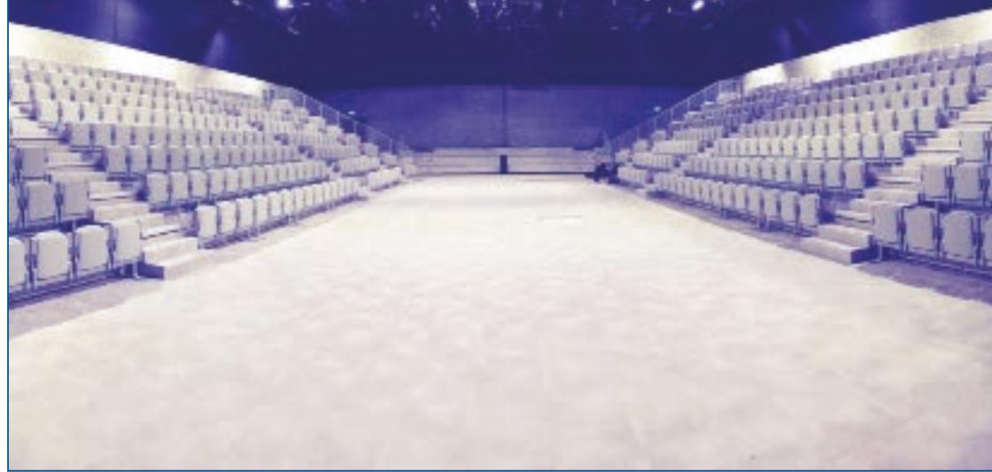
Progettate con una tecnologia d'avanguardia, le tribune telescopiche permettono di modulare lo spazio all'interno di strutture chiuse. Essendo facilmente estraibili, possono infatti aumentare sensibilmente il numero dei posti a sedere e, al termine dell'utilizzo, si trasformano in un mobile di minimo ingombro che valorizza l'ambiente sia dal punto di vista funzionale che architettonico.
