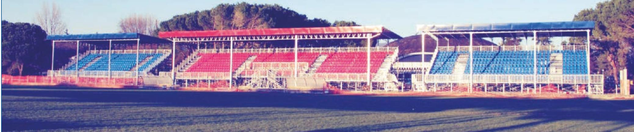
Le tribune prefabbricate e i palchi CETA possono essere dotati di **coperture standard o a sbalzo**. Queste coperture si differenziano per **robustezza e velocità di installazione** e vengono realizzate con struttura portante in acciaio zincato a caldo e manto in lamiera grecata zincata o verniciata o, in alternativa, pannelli sandwich.
